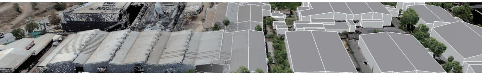
Функция моделирования здания на уровне детализации может быть основана на данных облака точек и векторных данных контура здания. Программное обеспечение обеспечивает полуавтоматическое извлечение контуров зданий и поддерживает загрузку нескольких источников данных в несколько окон для связанного отображения и фильтрации по высоте, чтобы помочь в построении контуров и редактировании модели для получения правильных результатов.
